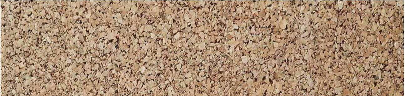
**Il sughero è lodato per le sue proprietà naturali di isolamento termico e acustico**, che lo rendono una scelta eccellente per pavimenti, rivestimenti murali e sottofondi. È leggero, **resistente a muffe**, funghi e acqua, caratteristiche che ne aumentano l'attrattiva nel settore delle costruzioni. Inoltre, la naturale elasticità del sughero offre un effetto confortevole e ammortizzante sotto i piedi, migliorando ulteriormente il *comfort* degli interni.
